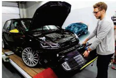
**4 AUFSETZEN** Sind die Lichter getauscht, kann die Frontschürze wieder aufgesetzt werden. Zu zweit geht das einfacher.
