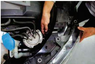
**3 EINSTECKEN** Der Scheinwerfer wird mit dem Lampenkabel verbunden – „Plug-and-play“ heißt die simple Einbaulösung.
