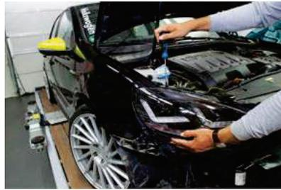
**2 AUSTAUSCHEN** Der neue Scheinwerfer wird einfach eingeschoben. Fixierstifte am Blech sorgen für die Platzierung.
